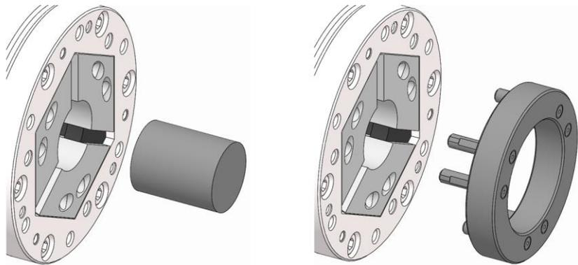
2. Den Ausdrehbolzen in das Spannmittel einsetzen, so dass dieser durch die Bearbeitung des HSW-Spannkopfes nicht beschädigt wird. Beziehungsweise den Ausdrehring in den HSW-Spannkopf bis auf Anschlag einsetzen, sodass die Stifte des Ausdrehrings und die Wechselbohrungen des HSW-Spannkopfes übereinstimmen.
