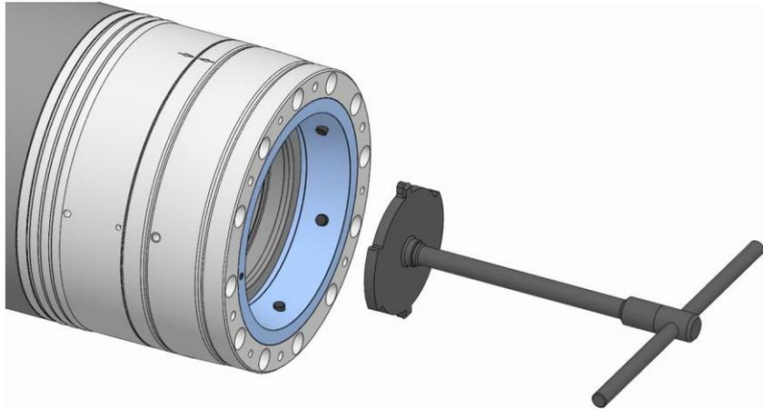
5. Die Montagehilfe in die Funktionseinheit einsetzen, so dass die Montagehilfe in die Nuten des Zugrohradapters der Funktionseinheit eingreift.
