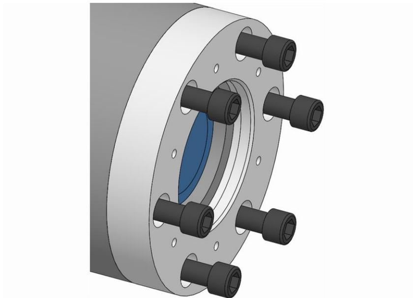
3. Die Befestigungsschrauben Spindelflansch lösen und entfernen.
