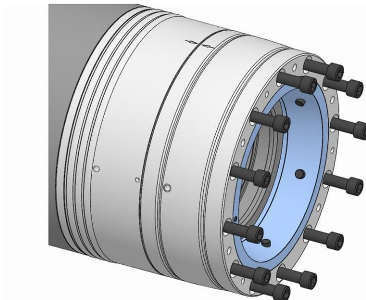
9. Die Befestigungsschrauben Funktionseinheit einschrauben und diese mit dem vorgeschriebenen Anzugsdrehmoment festziehen [siehe Kapitel »Schraubenanzugsdrehmomente«].
