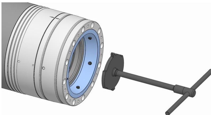
7. Die Montagehilfe aus der Funktionseinheit herausnehmen.
