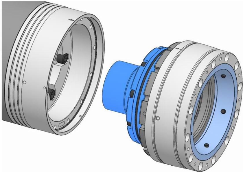
9. Die Funktionseinheit von dem Spindelflansch herunternehmen.
