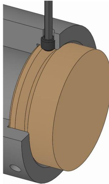
2. Die Klemmschrauben Wechselteil hineindrehen und mit dem vorgeschriebenen Anzugsdrehmoment festziehen [siehe Beschriftung].
