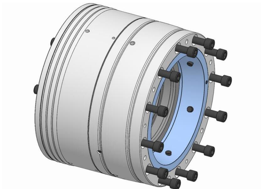
4. Die Befestigungsschrauben Funktionseinheit lösen und entfernen.
