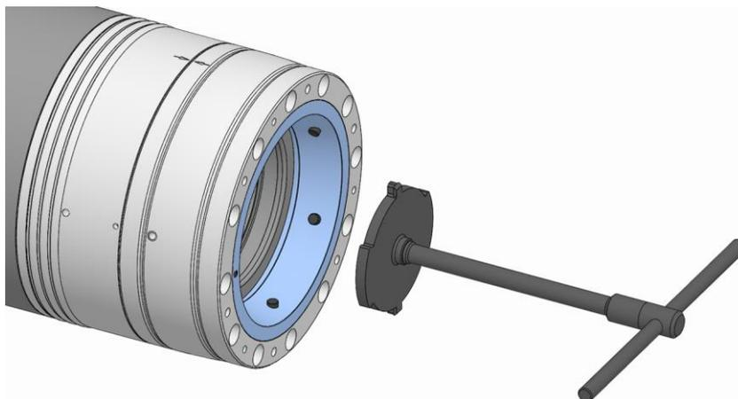
7. Die Montagehilfe aus der Funktionseinheit herausnehmen.
