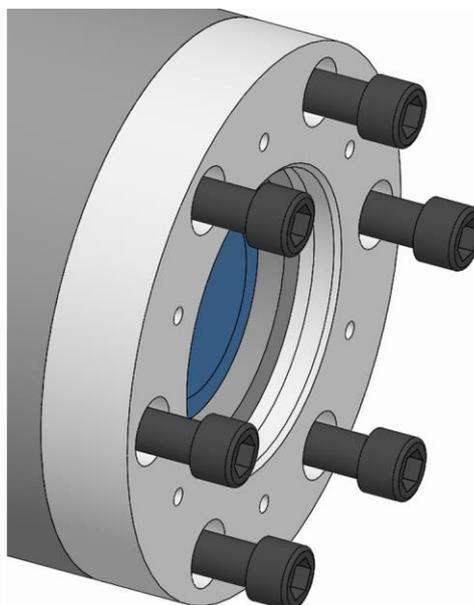
4. Die Befestigungsschrauben Spindelanschlag einschrauben und diese leicht anlegen.
