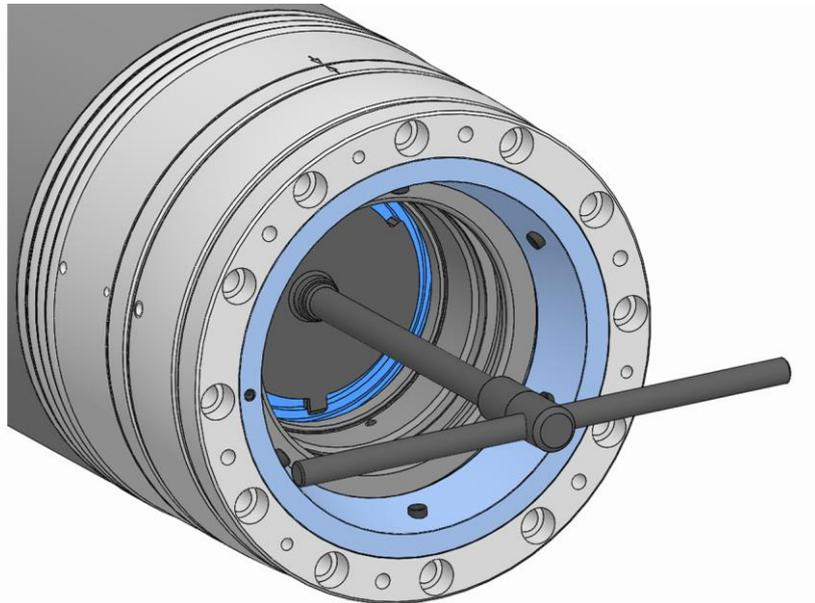
6. Den Zugrohradapter der Funktionseinheit mit der Montagehilfe auf das Zugrohr der Maschine bis auf Anschlag aufschrauben.
