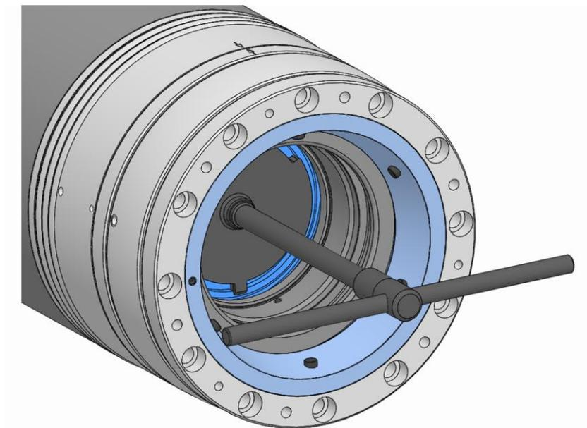
7. Den Zugrohradapter der Funktionseinheit mit der Montagehilfe von dem Zugrohr der Maschine herunterschrauben.
