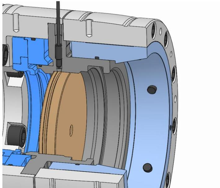
1. Die Klemmschrauben Grundanschlag herausdrehen bis sich der Grundanschlag herausnehmen lässt.
