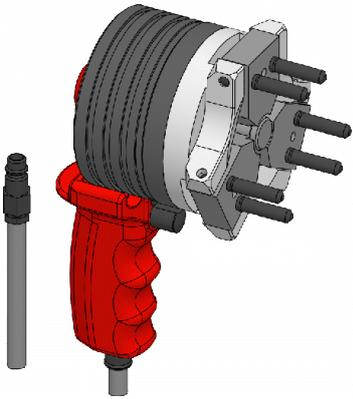
Die Stifte der Wechsellvorrichtung werden in die Wechselbohrungen im Spannkopf eingesetzt. Die Wechsellvorrichtung wird mittels Druckluft betätigt. Je nach Baugröße ist die Wechsellvorrichtung für eine Ein- oder Zweihandbetätigung ausgelegt. Der Spannkopf ist fest in die Wechsellvorrichtung eingespannt und kann mit Hilfe der Wechsellvorrichtung in das montierte Spannmittel eingesetzt werden.
