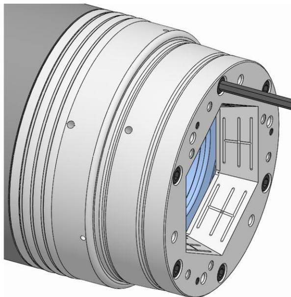
13. Die Befestigungsschrauben Spannelementaufnahme mit dem vorgeschriebenen Anzugsdrehmoment festziehen [siehe Kapitel »Schraubendrehmomente«].
