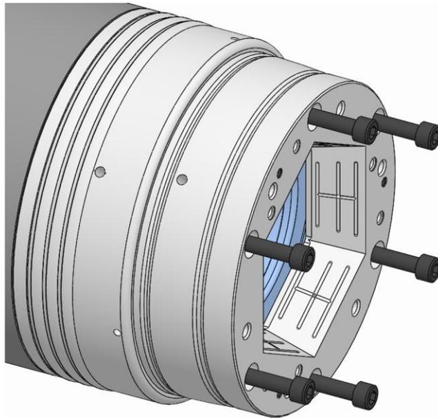
9. Die Befestigungsschrauben Spannelementaufnahme einschrauben und diese leicht anlegen.
