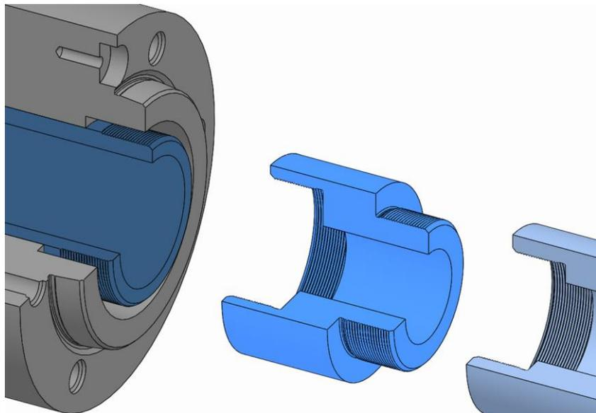
1. Den Zugrohradapter über dessen Gewinde in die Kupp-
