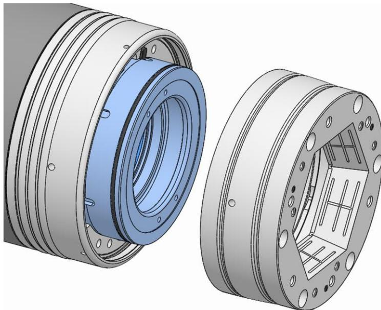
8. Die Spannelementaufnahme auf den Spindelflansch aufsetzen, sodass die Nut der Spannelementaufnahme und die Verdrehsicherung übereinstimmen.
