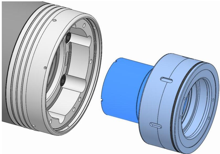
4. Die Kupplung gegebenenfalls mit Zugrohradapter auf das Zugrohr der Maschine bis auf Anschlag aufschrauben.
