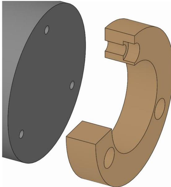
1. Das Wechselteil auf das Produkt aufsetzen.
