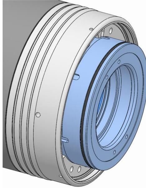
5. Die Kupplung zurückdrehen, bis die nächste Nut der Kupplung und die Nut des Spindelflansches übereinstimmen.
