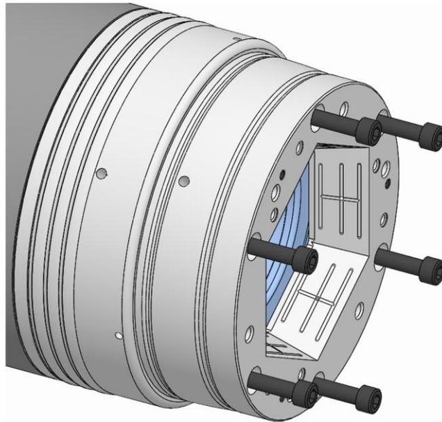
9. Die Befestigungsschrauben Spannelementaufnahme einschrauben und diese mit dem vorgeschriebenen Anzugsdrehmoment festziehen [siehe Kapitel »Schraubenanzugsdrehmomente«].
