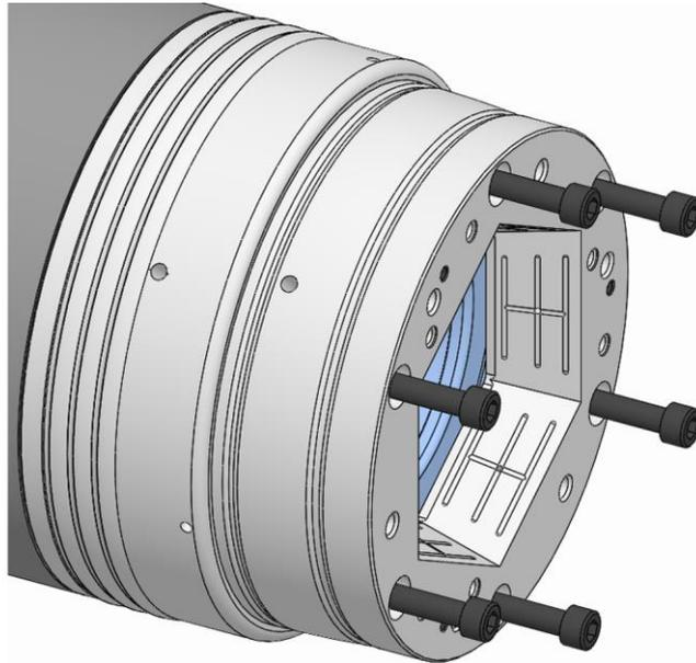
4. Die Befestigungsschrauben Spannelementaufnahme lösen und entfernen.
