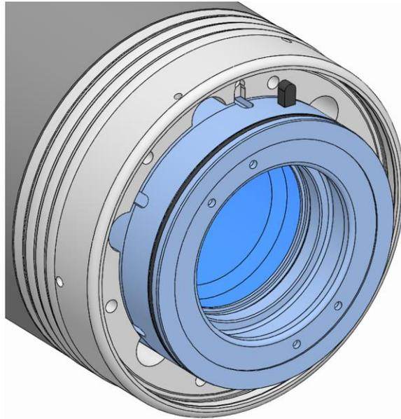
7. Die Verdrehsicherung Kupplung senkrecht zum Nutgrund in die Kupplungsnut einsetzen und in die Nut im Spindelflansch drücken.
