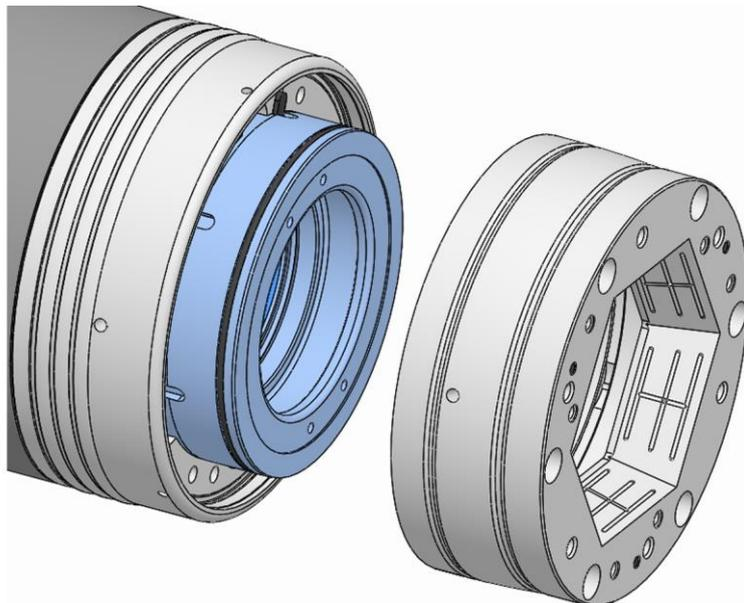
5. Die Spannelementaufnahme von dem Spindelflansch herunternehmen.
