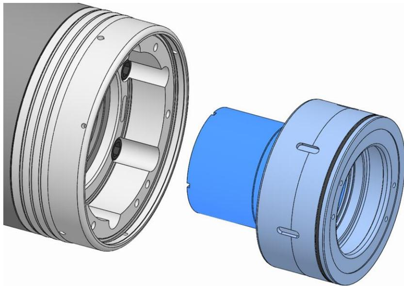
8. Die Kupplung gegebenenfalls mit Zugrohradapter von dem Zugrohr der Maschine herunterschrauben.
