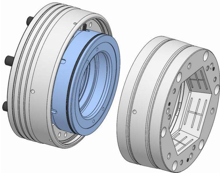
3. Die Spannelementaufnahme von dem Spindelflansch herunternehmen.
